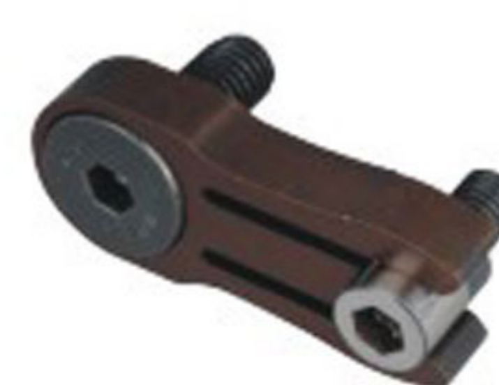
RCM D14 限位夾 SLIDE RETAINER M 材質 1.8159 H 硬度 HRC45°±3°
