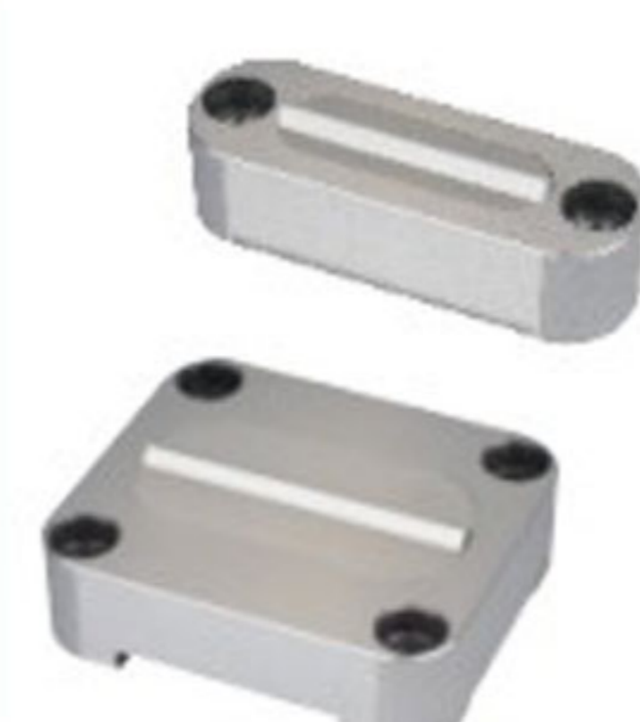
Z5140 D10 限位夾 SLIDE RETAINER M 材質 1.2343 H 硬度 HRC54°±2°
