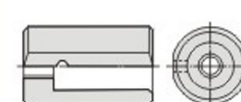
POBS D17 樹脂開閉器襯套 PARTING LOCKS BUSHINGS M 材質 S45C
